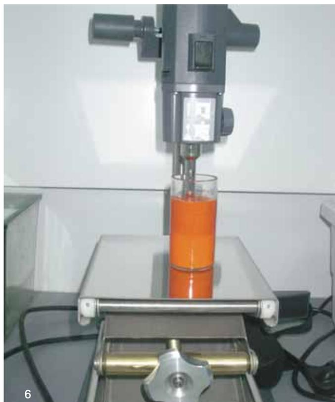
тивного вещества и с помощью той же мешалки получают новую, довольно устойчивую эмульсию типа «вода-масло-вода». В ней (фото 6) капельки раствора полимера с начинкой из доксорубина окружены водным раствором ПАВа, который не дает им слиться в одну большую каплю.
